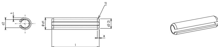
1) Pour les goupilles élastiques de diamètre d1 > 8mm, un chanfrein est facultatif d'un côté à la discrétion du fournisseur.
